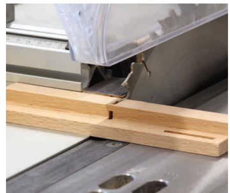
1 | Basis und Schlitten fertigen Sie zur sichereren Handhabung aus einem langen Stab. Er wird so gefälzt, dass die späteren Teile aufeinander gelegt wieder die Originaldicke haben. Hier kommt es aber nicht auf einen Zehntelmillimeter an.
