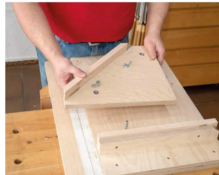
**2 |** Wenn sie nicht ständig unterschiedliche Winkel bestoßen, reichen auch austauschbare Anschläge für die wichtigsten Winkel aus. Die Anschläge werden einfach mit Flügelmuttern auf der Stoßlade befestigt.
