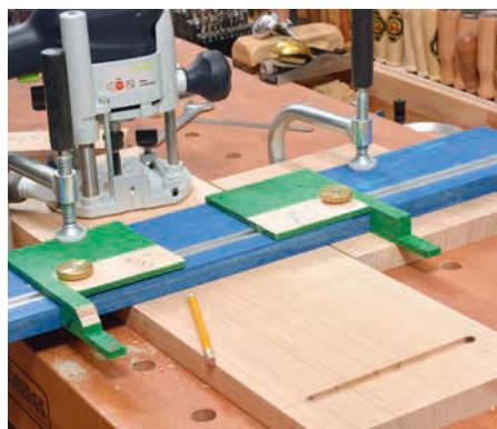
**11** Wenn Sie die Anschlagplatte genau rechtwinklig entlang der Werkstückkante herunterführen, müssen Sie für eine weitere, identische Nut nicht einmal die Reiter verstetzen. Hier hilft eine Markierung auf der blauen Plattenkante.
