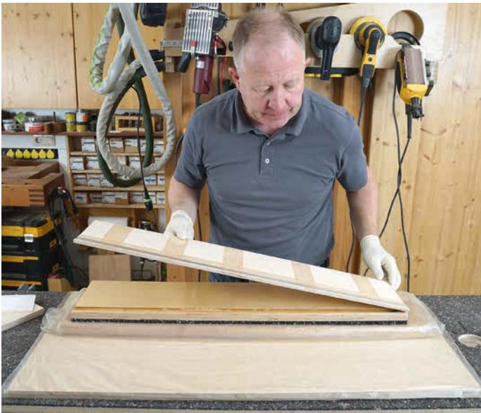
7 | Da die zweite Außenseite etwas stabiler ist als die Variante mit der weichen Bautenschutz-Matte, kann sie von oben auf die Mittellage gelegt werden.
