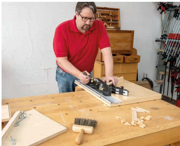
**1 |** Egal ob einfach oder High-End: Stoßlade werden in der Regel auf der Hobel- oder Werkbank befestigt. So hat man eine angenehme Arbeitshöhe und weder die Lade noch das Werkstück verrutschen.
