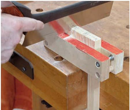
**6** Nach dem Übertragen der Zinkenkonturen auf das Schwalbenbrett komm nun dieses zwischen die Spannblock-Backen. Die genaue Position wird wieder mit dem angrenzenden Werkstück ermittelt.
