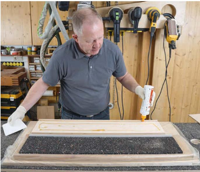
5 | Platzieren Sie beim Zusammenkleben die erste Lage auf einer weiteren Platte, die später als Zulage zum Spannen dient. Eine untergelegte PE-Folie verhindert ungewolltes Anhaften. Dosieren Sie die Auftragsmenge so, dass möglichst kein Überschuss entsteht.
