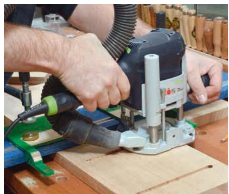
**12** Nut für Nut lässt sich so nach nur wenigen Sekunden Umbauzeit fräsen. Ausgerichtet wird jedes Mal erneut mit der Anschlagleiste. Falls diese wie hier nicht zwischen die fixierten Reiter passt, schneiden Sie einfach ein kürzeres Exemplar.
