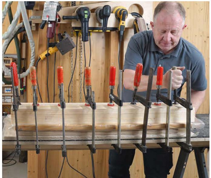
8 | Die Zulagen verteilen den Druck der Schraubzwingen auf die Fläche. Nach dem Trocknen des PU-Klebers können Sie das Klebeband entfernen.
