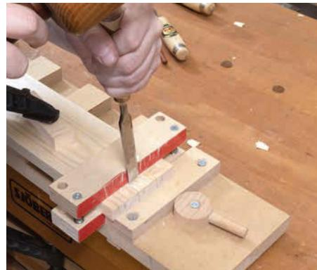
**5** Durch die Begrenzung der Backen kann das Stecheisen gar nicht zu weit in die Brettfläche nutzen. Arbeiten Sie bis zur Hälfte herab, dann drehen Sie den Spannblock samt Werkstück und arbeiten von der anderen Seite.
