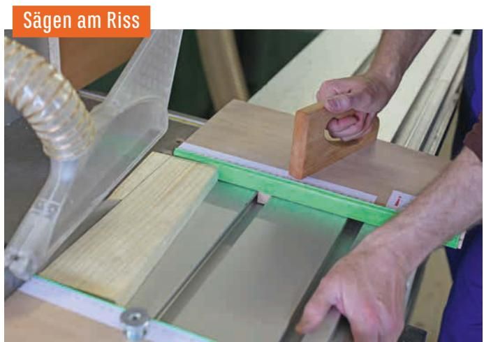
Beim allerersten Schnitt werden Fritz und Franz auf ihr Maß getrimmt und reichen ab diesem Zeitpunkt bis ans Sägeblatt heran. So können selbst schräge Schnitte nach Anriß problemlos ausgeführt werden. Normalerweise braucht es hierfür eine aufwändige Schablonenkonstruktion.
