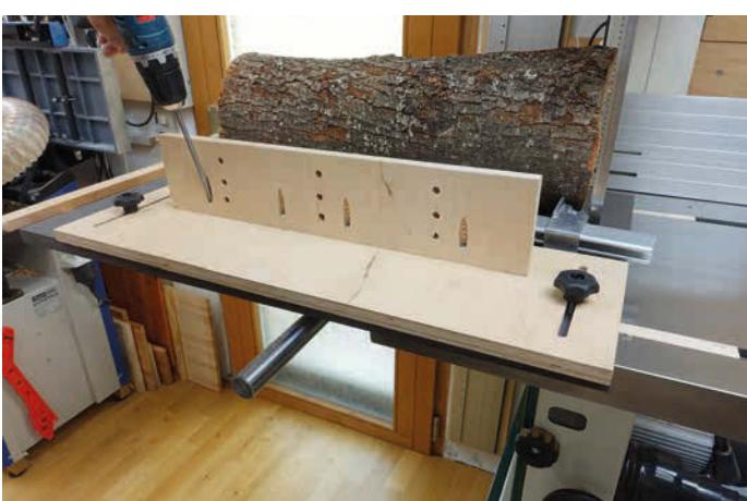
**9** Die Spannlade für Längsschnitte besteht aus einer liegenden Grundplatte (MPX 650 x 200 x 15 mm) und der stehenden Halteplatte für die Verleimzwinge (480 x 100 x 15 mm). Die Halteplatte ist per Taschenloch-Verschraubung mit der Grundplatte verbunden.
