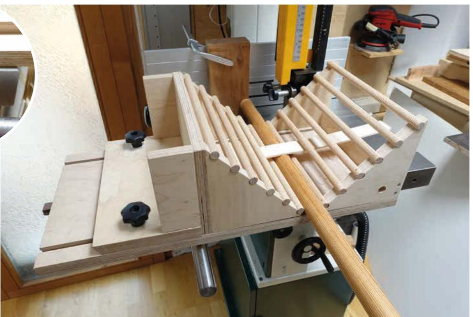
**8** Die Lade kann auch direkt mit einer Nutleiste in der T-Nut des Sägetisches geführt werden (Detailfoto). Die vordere Halterung ist jetzt so positioniert, dass auch ein dünner Stab sicher Halt findet. Ein Streifen dünner Furnierplatte drückt den Rundstab fest in die Halterung.
