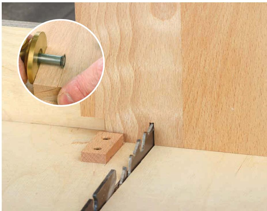
**15 |** Das erste Brett ist geschlitzt. Den ersten, außen liegenden Schlitz des folgenden Brettes müssen Sie mit 20 mm anzeichnen. Sägen Sie dann nach Anriss. Alle weiteren Schlitte ergeben sich durch den Einsatz der Vorrichtung wie oben beschrieben.
