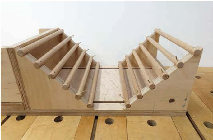
**6** Mit Sockelleisten-Stiften 1,7 x 25 mm werden die Dübelstangen auf ihre Halterungen genagelt. Die Dübelstangen unbedingt vor dem Annageln mit einem 2-mm-Bohrer vorbohren. Die Nägel würden die Enden der Dübelstangen sonst spalten.
