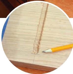
**10** Fräsen Sie nun von Anschlag zu Anschlag. Wenn der Absaugschlauch immer noch stört wie hier, lässt sich der Reiter noch etwas abschrägen (Kreis). Das Ergebnis des Fräsdurchgangs: Eine punktgenau eingesetzte Fräzung (kleines Bild).
