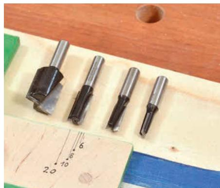
**7** Und so geht es weiter, bis Sie alle gewünschten Fräser erfasst haben. Alternativ können Sie die Markierungen natürlich auch rechnerisch festlegen: Der Abstand zwischen den Markierungen etwa für einen 6-mm und einen 8-mm-Fräser beträgt die halbe Differenz der beiden, also einen Millimeter.
